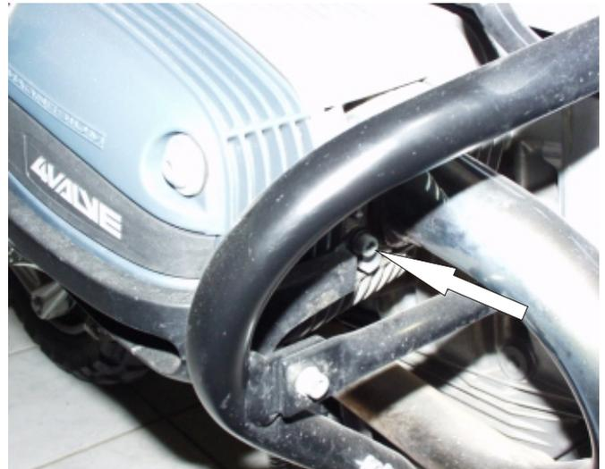
**Alle Schrauben bei der Montage zunächst nur ansetzen. Erst wenn alle Schrauben angesetzt sind die Schrauben anziehen.**
